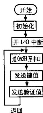
图 8 发送程序流程简图
